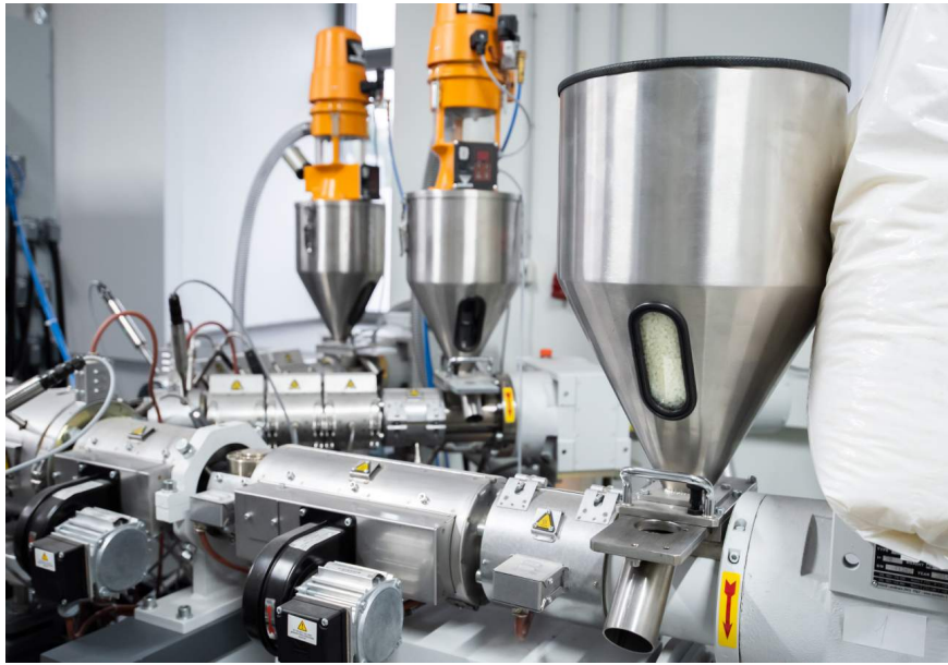
Figura 1: Proceso de Extrusión. (Corzosa, 2021)
