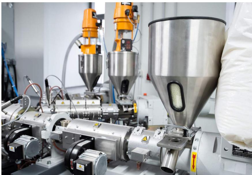
**Figura 4:** Proceso de Extrusión.
