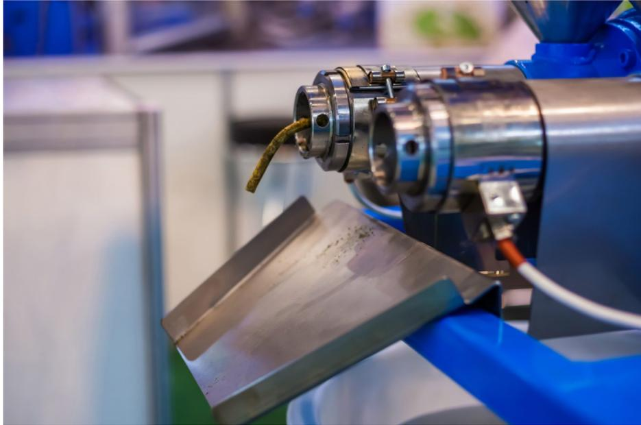
**Figura 5:** Molde de extrusión.
